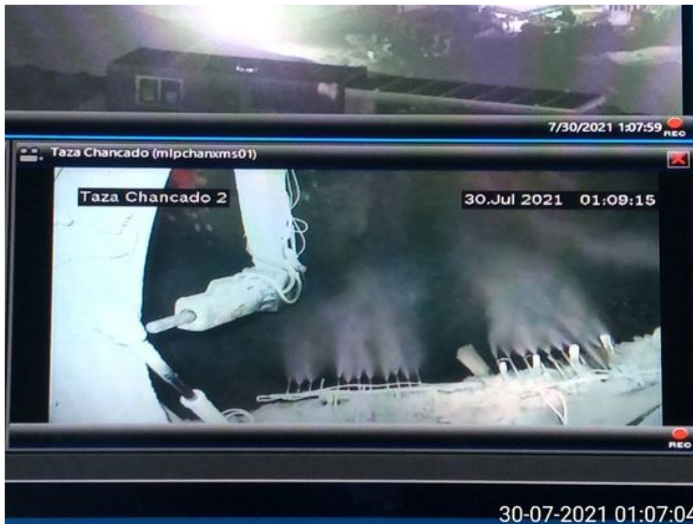
Foto 10: Medida: Supresor de polvo. Lugar: Taza Chancado 2. Comentarios: Supresores operativos , medida no es suficiente para mitigar material particulado en suspensión por descarga de caex en taza de chancado .
