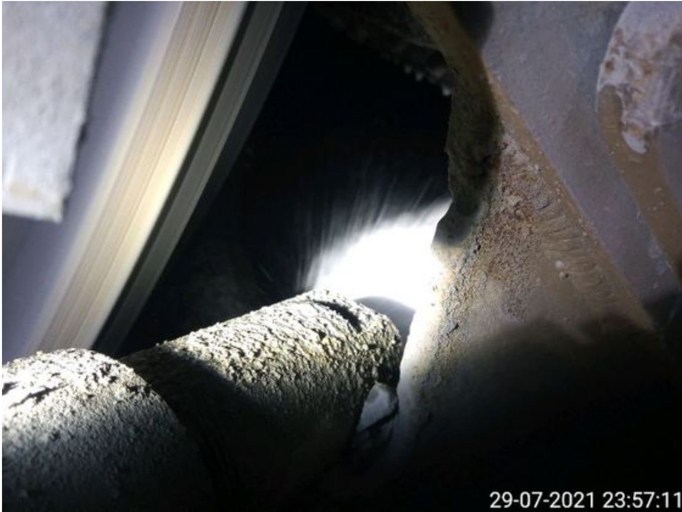
Foto 7: Medida: Aplicación Espuma Surfactante. Lugar: Correa CV 007. Comentarios: Espuma Surfactante operativa .
